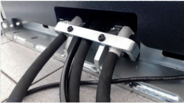
Si fuera necesario cambiar los tubos hidráulicos por desgaste prematuro, se recomienda instalar este soporte, donde no esté presente, en los modelos de elevador que se indican a continuación:
